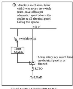
SCHEMATIC LAYOUT FOR TIMER CONTROL CIRCUITS
